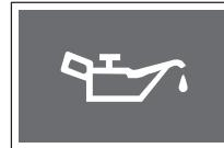
Kontrolka tlaku motorového oleje se rozsvítí tehdy, když je spínač START/STOP v poloze ON a vypne se po nastartování motoru.
