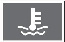
Pokud je teplota chladící kapaliny motoru příliš vysoká, začne blikat kontrolka přehřátí motoru a zazní varovný zvukový signál.
