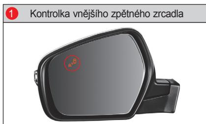
Když kontrolka vnějšího zpětného zrcadla blikne dvakrát a spínač START/STOP je v poloze ON, nebo když motor běží, znamená to, že systém varování vzadu a na boku funguje normálně.
