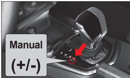
Když přeřadíte řadicí páku z polohy D (jízda) do polohy +/- (manuál), řidič může měnit převod (1.-6.) manuálně jako u manuálního převodu.
