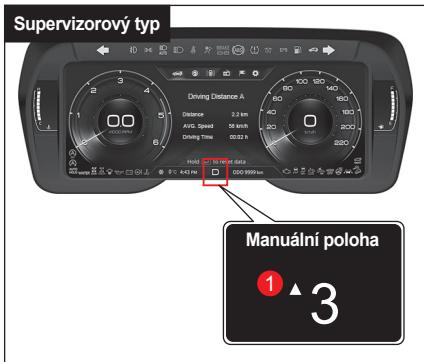
▲ 3 Tohle označuje nevhodnější moment na přeřazení na 3. převodový stupeň (cíl), když je ve vozidle zařazen 1. nebo 2. převodový stupeň.
