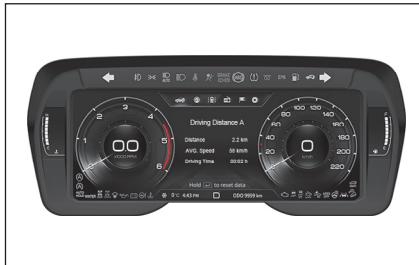
Zkontrolujte, zda všechny indikátory a kontrolky na přístrojovém panelu správně svítí, když je spínač zapalování v poloze **ON**.
