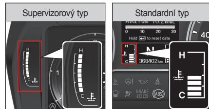
Udává teplotu chladící kapaliny motoru.
