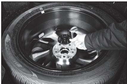
Otevřete kryt v zavazadlovém prostoru a vyberte náhradní (dojezdovou) pneumatiku.
