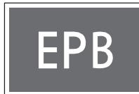
Kontrolka elektronické parkovací (ruční) brzdy (EPB) se rozsvítí tehdy, když je spínač START/STOP v poloze ON a zhasne po přibližně 4 sekundách.
