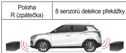
Když se řadičí páka zařadí do polohy **R** (zpátečka), 4 senzory detekce přední překážky a 4 senzory detekce zadní překážky se aktivují najedou.
