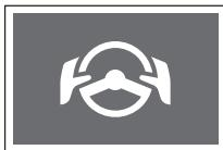
Když dá řidič ruce dolů z volantu po určitou dobu, když je zapnuta funkce LKAS a Inteligentní řízení jízdy, zazní zvukový signál a rozsvítí se kontrolka.
