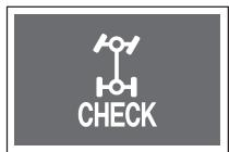
Kontrolka KONTROLA 4WD se rozsvítí a pak zhasne po cca 4 sekundách po zapnutí spínače zapalování.
