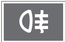
Když jsou zapnuty přední světla a spínač otočíte do polohy
