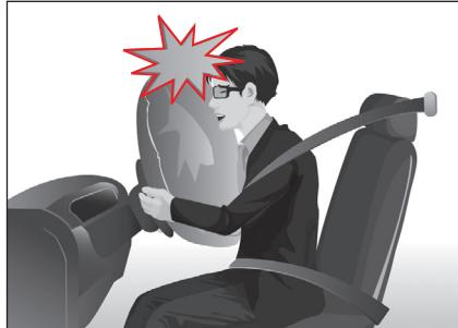
Pokud se vozidlo převrátí na bok anebo na střechu cestující nemůže být plně chráněný samotným airbagem. V takovém případě se airbag nemusí nafouknout.
