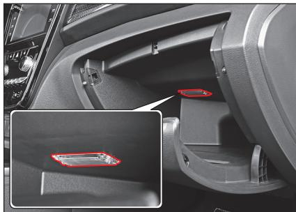
Když otevřete odkládací schránku, světlo se zapne a když zavřete odkládací schránku, světlo se vypne.
