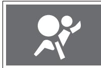
Kontrolka airbagu se rozsvítí tehdy, když je spínač START/STOP v poloze ON a vypne se, když v systému airbagu není žádná abnormalita.
