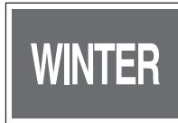
Když otočíte a podržíte a pak uvolníte spínač módu jízdy ve směru hodinových ručiček, rozsvítí se indikátor módu WINTER.
