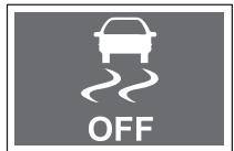
Indikátor ESP OFF se rozsvítí, když je spínač START/STOP v poloze ON a zhasne po přibližně 4 sekundách.
