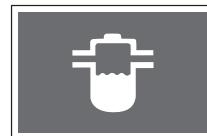
Pokud voda v palivovém filtru přesáhne předepsanou hladinu, rozsvítí se kontrolka separátoru vody a klesne hnací síla motoru, přičemž zazní varovní zvukový signál.
