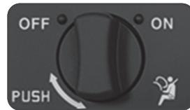
Airbag spolucestujícího na předním sedadle bude vypnutý (nenafoukne se), když otočíte spínač ON/OFF airbagu spolucestujícího do polohy OFF. Tento spínač se nachází na pravé straně přístrojového panelu a uvidíte ho tehdyn, když otevřete přední dveře spolucestujícího. Když chcete tento spínač použít, stiskněte ho a otočte. Poloha OFF: funkce je vypnuta (nenafoukne se) Poloha ON: funkce je zapnuta (nafoukne se)
