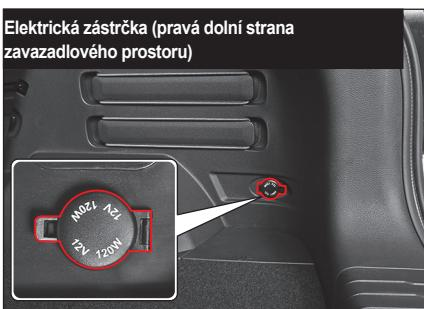
Ve vozidle je instalovaná elektrická zástrčka (12 V, 120 W), co umožňuje použití separátního elektrického zařízení.
