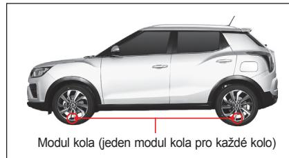
Elektronická kontrolní jednotka TPMS dostává různé údaje, včetně tlaku v pneumatikách a teploty z modulu kola, který je instalovaný na každém kole a zobrazuje tyto údaje na přístrojovém panelu.
