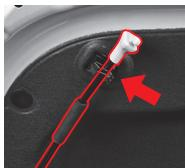
Před zavřením kapoty se přesvědčte, či je tyč pevně upevněná ve svorce.
