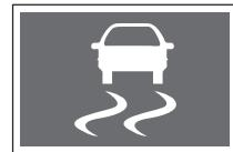
Indikátor ESP ON se rozsvítí tehdy, když je spínač START/STOP v poloze ON a zhasne po přibližně 4 sekundách.
