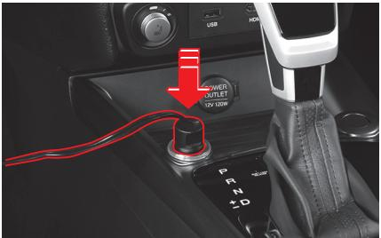
**10** Kompresor aktivujte stisknutím spínače v sadě nástrojů.
