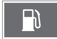
Pokud je hladina paliva nedostatečná, rozsvítí se kontrolka nízké hladiny paliva. Doba, kdy se kontrolka rozsvítí, se může měnit podle stavu vozidla nebo sklonu kopce.
