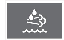
Kontrolka SCR se rozsvítí tehdy, když je spínač START/STOP v poloze ON a vypne se po nastartování motoru.
