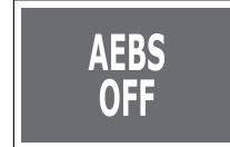
Když jsou systém AEBS a funkce ESP deaktivovány, na přístrojovém panelu se rozsvítí indikátor AEBS OFF.
