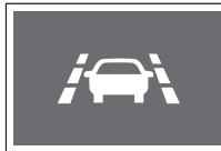
Stisknutím spínače asistenta dodržení jízdního pruhu (opuštění pruhu) aktivuje varování na dodržení jízdního pruhu a opuštění pruhu podle nastavení vozidla.
