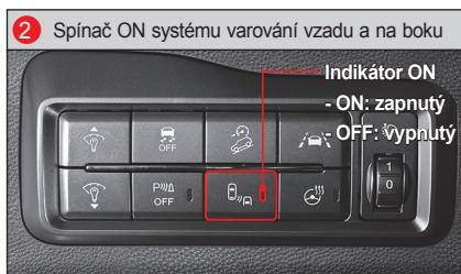
Když vypnete motor a systém varování vzadu a na boku je deaktivován a vy nastavíte spínač START/STOP do polohy ON, systém se zapne bez toho, aby se vrátil na předchozí stav.
