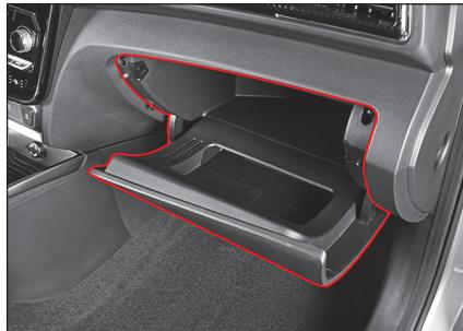
Odkládací schránku lze využít na odložení dokumentů týkajících se registrace vozidla anebo na jiné předměty, které se používají ve vozidle.
