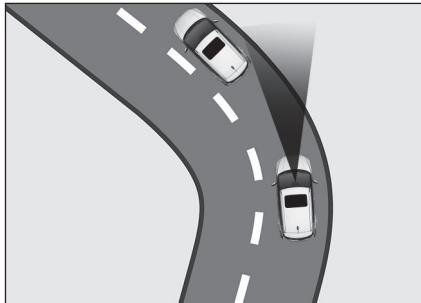
Na cestě se zatáčkami nelze detekovat vozidlo vepredu, které jede ve stejném pruhu a výkon AEBS je nižší, takže se může objevit nepotřebná varování nebo brzdění, nebo systém nebude fungovat.
