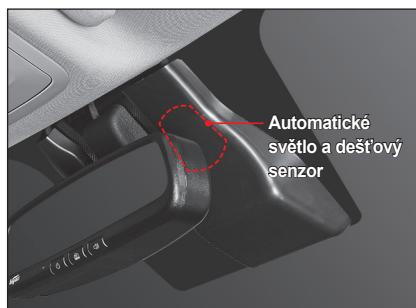
Dešťový senzor je integrován do senzoru automatického světla.
