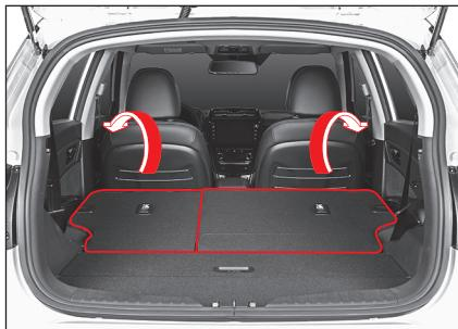
Když vracíte opěradlo do původní polohy, postupujte opačným směrem.
