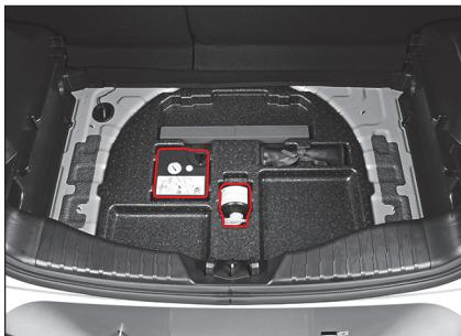
Sada nástrojů na opravu pneumatiky je uložena v úložném prostoru na zadní levé straně zavazadlového prostoru s dalšími nástroji.
