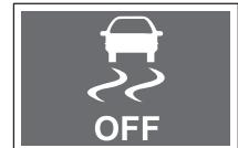
Když deaktivujete ESP stisknutím a podržením spínače ESP OFF (na 3 vteřiny nebo déle), rozsvítí se indikátor.
