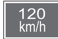
Tato kontrolka bliká s opakováním varovným zvukovým signálem (5 krát), když rychlosť vozidla přesáhne 120 km/h.
