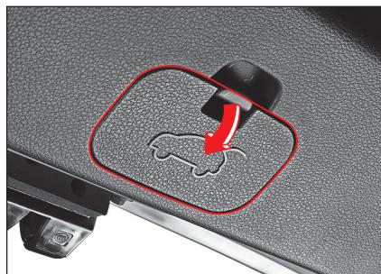
2 Pokud chcete odemknout výklopné zadní dveře, zatáhněte doprava bezpečnostní páku uvolnění uvnitř panelu.
