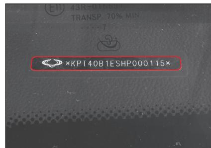
VIN je vyražené na horní straně přístrojového panelu.
