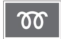
Indikátor žhavení se zapne, když je spínač START/STOP v poloze ON a vypne se tehdy, když jsou zásuvky žhavení úplně horké. Nastartujte motor až poté, když indikátor žhavení zhasne.
