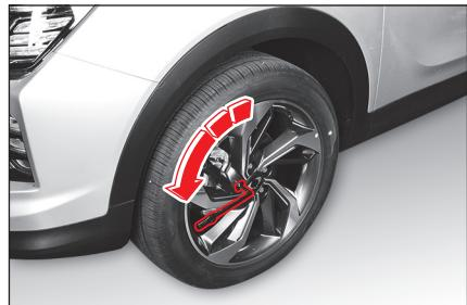
Pokud jsou matice na kole upevněny příliš silně, mohou se poškodit. Neutahujte matice na kole stláčením klíče na matice nohou nebo jiným pomocným nástrojem.
