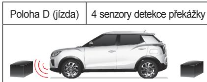
Senzor detekování přední překážky se aktivuje tehdy, když se řadičí páka zařadí do polohy **D** (jízda).
