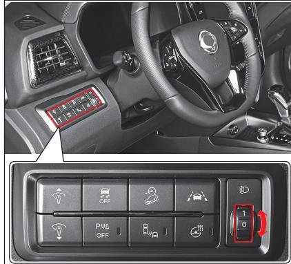
Přední a zadní sklon vozidla se mohou měnit v závislosti na počtu cestujících, hmotnosti a těžišti nákladu.
