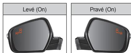
Když je detekováno vozidlo na zadní a boční straně vozidla, na vnějším zpětném zrcadle se rozsvítí žluté světlo indikátoru.
