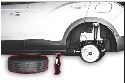
**6** Vyberte kolo a dejte jej pod karoserii vozidla. Tohle pomáhá minimalizovat nebezpečí v případě, když zvedák vyklouzne spod vozidla.
