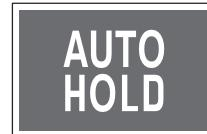
Když stisknete tlačítko AUTO HOLD, systém AUTO HOLD se přepne do módu připravenosti a na přístrojovém panelu se rozsvítí indikátor AUTO HOLD.
