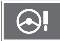
Kontrolka elektrického řízení se rozsvítí tehdy, když se zapne spínač zapalování a zhasne, když se spínač zapalování vypne.
