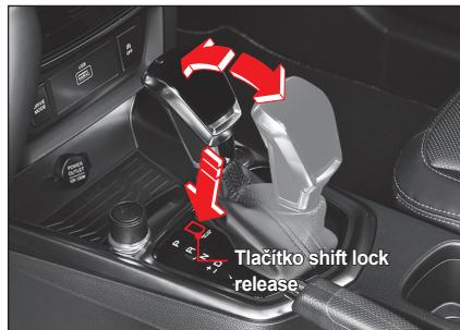
Přestože jste použili řadící páku podle postupu zařízení, ale páka se nepohne z polohy P (parkování) do jiné polohy, pohněte ji manuálně následovně:
