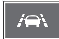
Když je systém varování před opuštěním jízdního pruhu aktivován, na přístrojovém panelu se rozsvítí indikátor.
