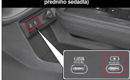
Nabíjecí port USB (přední strana držáku nápojů předního sedadla)
