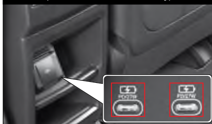
Nabíjecí port USB (zadní strana středové konzoly)
