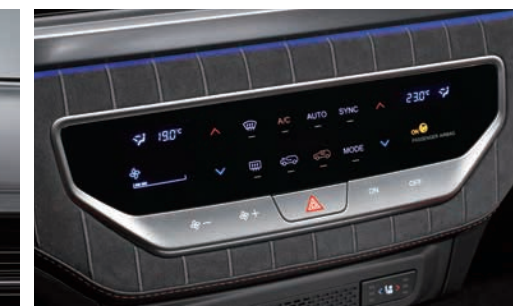
OVLÁDÁNÍ DVOUZÓNOVÉ PLNĚ AUTOMATICKÉ KLIMATIZACE
