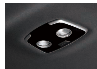
LED osvětlení interiéru
