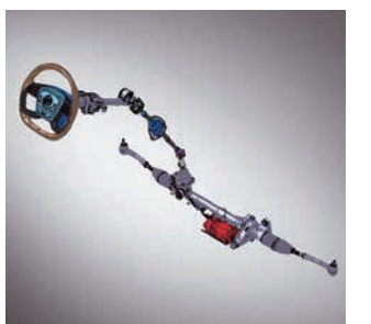
Elektrický posilovač řízení (R-EPS)
