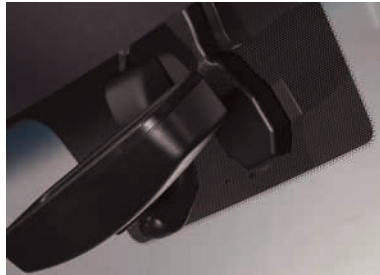
Přední kamerový modul s dešťovým senzorem a jednotkou pro automatické zapínání dálkových světel
