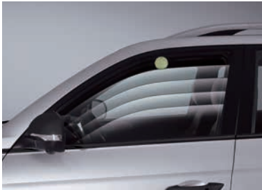
Elektrické ovládání oken s ochranou proti přivření
